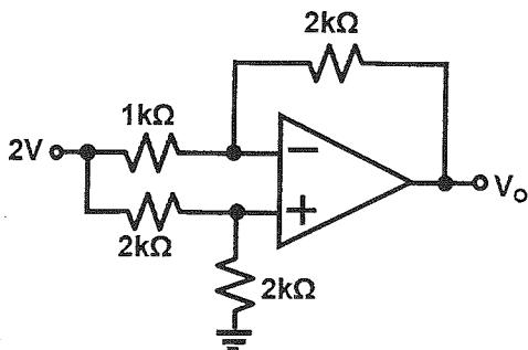
2. 考慮下圖電路，若運算放大器為理想。假設在  $t \leq 0$  sec 時，輸入電壓  $V_1=0V$ 、 $V_2=0V$ 、 $V_o=0V$ ；在  $t > 0$  sec 時，輸入電壓  $V_1=2V$ ,  $V_2=2tV$ ，請問  $t=2$  sec 時，輸出電壓  $V_o$  為多少伏特？（答案請標正負號）
