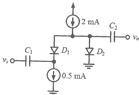
6. 如下圖所示之電路，假設二極體之導通電壓為  $0.7\text{V}$ ，且導通內阻為  $0\Omega$ 。求電流  $I = \underline{\hspace{2cm}}$  A。（答案請標正負號）
