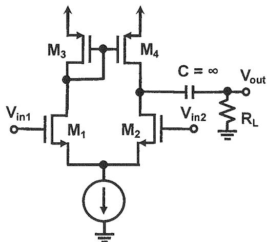
19. 如圖之放大器，電晶體都操作在飽和區。以下的單項設計變化，哪些可以增加差動電壓增益之絕對值( $|A_v| = |v_{out}/(v_{in1} - v_{in2})|$ )？(全對才給分)
