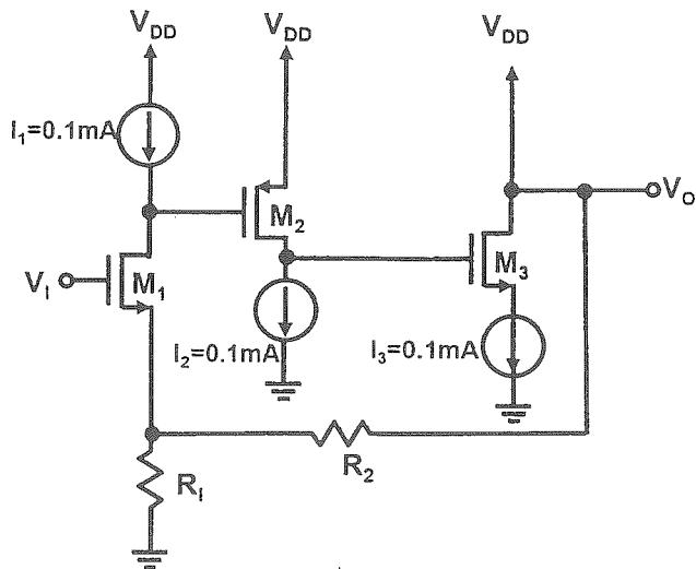
15. 已知某一個電壓取樣電壓迴授放大器採用一開迴路電壓放大器進行設計, 此開迴路電壓放大器的電壓增益為  $500 \text{ V/V}$ , 且其輸入阻抗為  $1 \text{ k}\Omega$ 。若量測得知此迴授放大器的輸入阻抗為  $100 \text{ k}\Omega$ , 求此迴授放大器的閉迴路電壓增益。(答案請標正負號)
