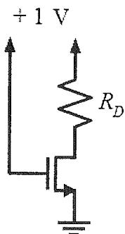
8. 如下圖所示之電路，假設電晶體之特性如下： $k'_n = 0.4 \text{ mA/V}^2$ ， $V_t = 0.5 \text{ V}$ ， $(W_2/L_2) = 10$ ， $(W_1/L_1) = 40$ ， $\lambda = 0$  (忽略channel-length modulation effect)。求電壓  $V_1 = \underline{\hspace{2cm}} \text{ V}$ 。(答案請標正負號)
