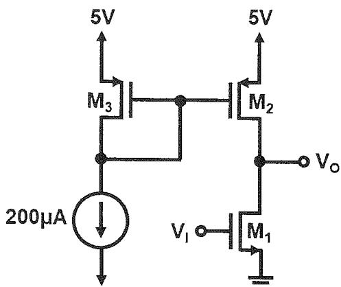
4. 考慮下圖電路，若  $\mu_nC_{ox}=20\text{mA/V}^2$ 、 $V_{THN}=1\text{V}$ ， $W_1=W_2=5\mu\text{m}$ ， $L_1=L_2=0.5\mu\text{m}$ ，請計算輸出阻抗  $R_o$ 。（答案請標單位）
