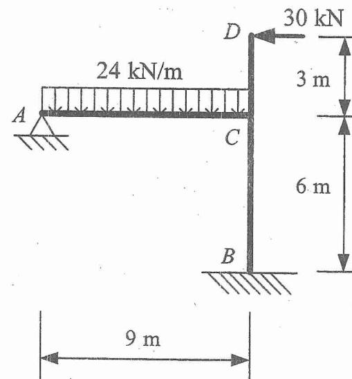
5. 試以矩陣位移法分析圖示構架，繪製剪力圖與彎矩圖。 $EI = \text{constant}$ 。(20%)
