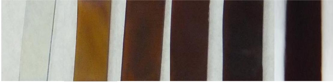
圖 4-2 ITO 試片及不同鍍膜次數(1~5 次)之  $\text{AgInS}_2$  薄膜。
