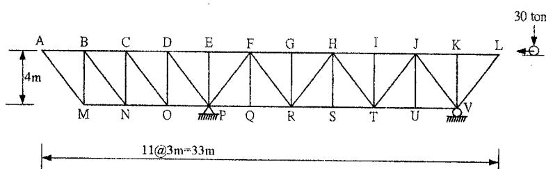
3. 如圖所示桁架，假設所有桿件之 EA 為常數，試求此結構節點 K 之垂直位移。(20 分)
