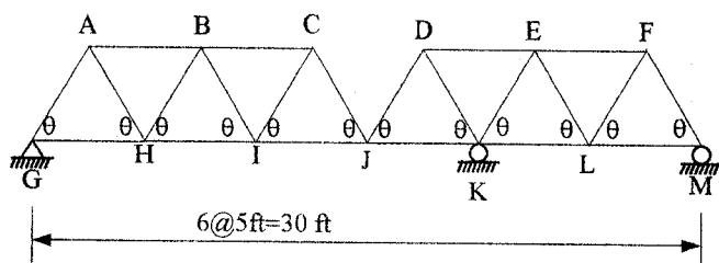
2. 如圖所示桁架承受一大小為 30 ton 之移動載重，假設所有桿件之斷面積均相同，試問此結構中桿件可能承受之最大軸向壓力(compressive force)大小為何？發生於那些桿件？(15 分)
