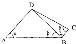
如圖，於無誤差之 A, B, C 三已知點等權觀測  $\alpha$ ,  $\beta$ ,  $\gamma$  及  $\delta$  等四個水平角。請探討下列命題是否成立：因  $\triangle ABC$  甚尖銳，故採用  $\alpha, \beta, \gamma, \delta$  計算所得 D 點坐標之誤差大於僅使用  $\alpha$  及  $\beta$  者。（15%）
