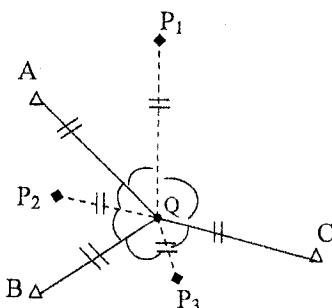
如圖，A, B, C 為平面控制點，P<sub>1</sub>, P<sub>2</sub>, P<sub>3</sub> 為待測點，請詳細討論下列二法之優劣：
