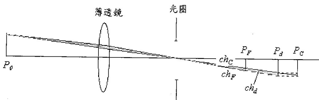
3. 有一雙筒望遠鏡系統如下圖所示，其規格為 8×25，前面數字 8 即是倍率 8 倍的望遠鏡，後面數字 25 即標示物鏡直徑為 25 mm，光圈位於物鏡上
