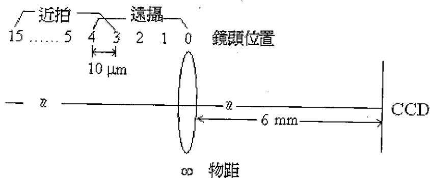
(c) 為減少光電系統處理時間，調整馬達精度為一步  $15 \mu\text{m}$ ，遠攝鏡頭位置從第零步至第三步，近拍鏡頭位置從第二步至第十步，遠攝其拍攝景物最近距離為何？
