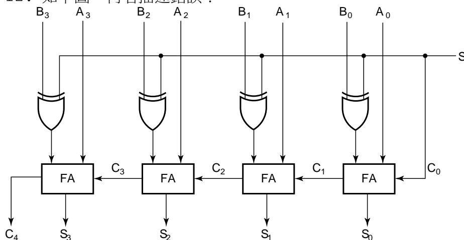
(A) 這是一個 4 位元加減法器電路 (B) 當  $S=1$ ，執行加法運算；(C) 圖中 XOR 邏輯閘是用於減法時的 B 的補數運算；(D) 四個 FA 構成 ripple-carry 加法器架構
