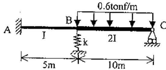
6. 試以彎矩分配法求桿件端點彎矩。假設  $EI=\text{constant}$ 。(20%)
