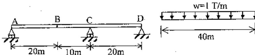
4. 試求圖示結構 C 點之垂直、水平位移及轉角，均須標示方向。(所有桿件之楊氏係數為  $E$ 。)
